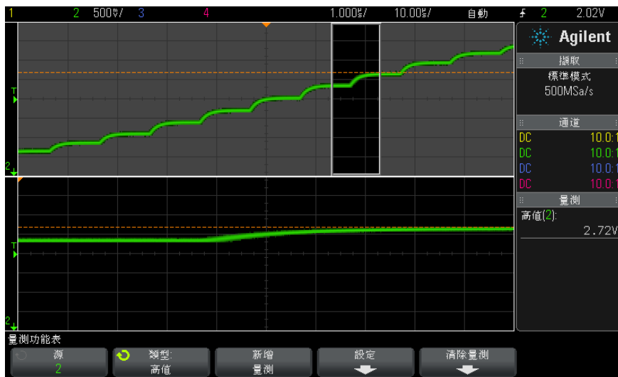
圖 33 區隔頂端量測的區域
